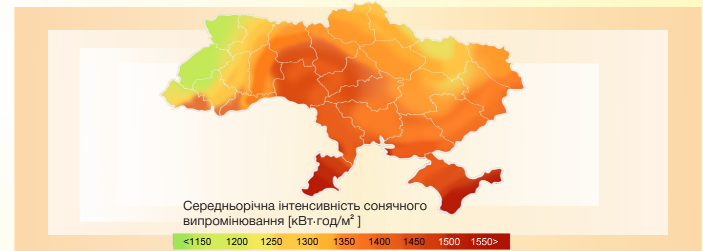
Рис. 1. Річні надходження сумарної сонячної радіації на горизонтальну поверхню в різних кліматичних зонах України
